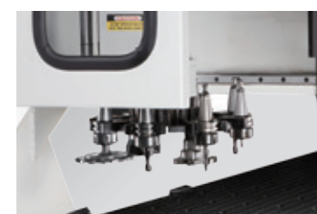
傘型刀庫 Drum type ATC
